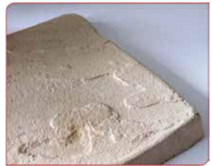
Bê tông xỉ lò cao dạng hạt MIDAR lát sàn
