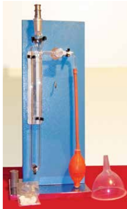
Hình5. Bộ phân tích độ mịn xi măng bằng phương pháp Blaine (còn gọi là máy Blaine).
