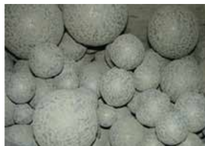
Hình 1. Vật liệu nghiền bị bao phủ bởi các hạt xi măng nếu không sử dụng phụ gia trợ nghiền.
