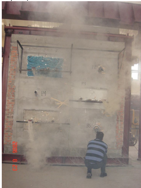
Hình 1. Thử nghiệm khả năng chịu lửa trong 4 giờ của hệ thống chèn bịt chặn lửa cháy lan qua lỗ thông tường - sản phẩm của Promat International (Asia Pacific)
