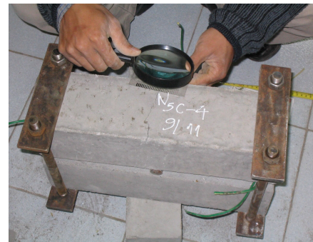
Hình 1. Mô hình thí nghiệm khả năng ức chế ăn mòn cốt thép của CN tại khe nứt
