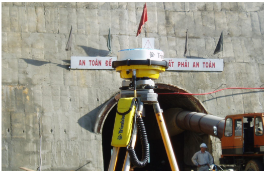
Hình 6a. Sử dụng hệ thống định vị GPS để dẫn toạ độ vào sát cửa hầm
