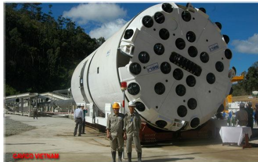
Hình 5. Máy đào hầm dạng khiên (a) và máy TBM (b)
